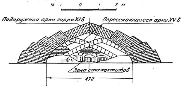
Рис. 63. Мавзолей Абул-Фазла. Пересекающиеся арки внутри подпружной арки трюма.
