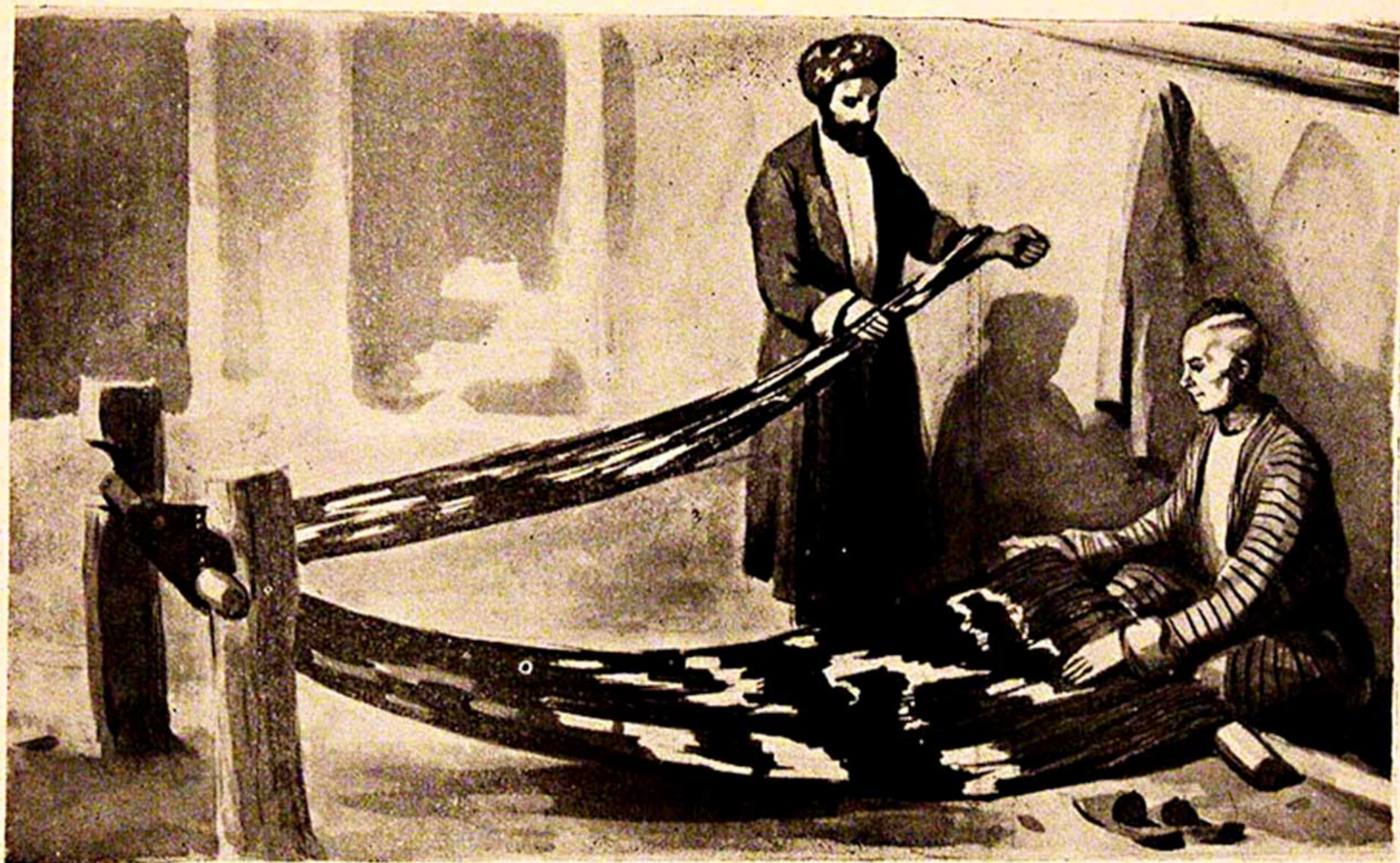
Рис. 20. Снятие резерва с основы после окраски. Рисунок (по фотографии С. Дудина).
