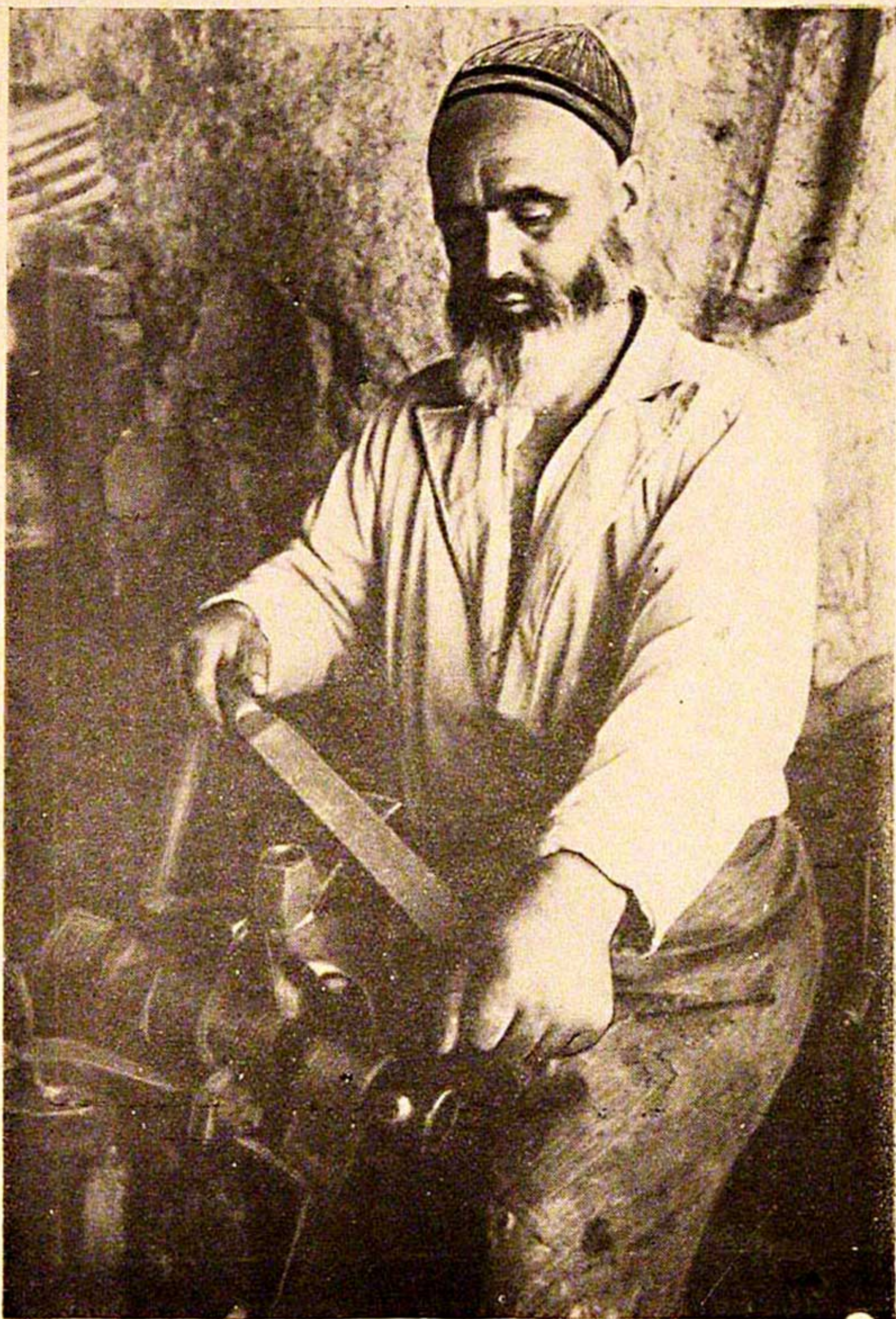
Рис. 1. Кузнец за работой. Шлифовка топорика, зажатого в тиски. Фото. * 13 1250
