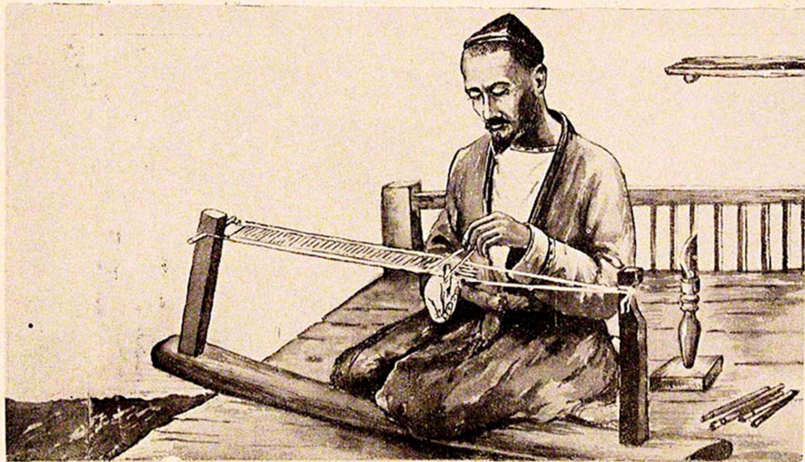
Рис. 16. Вязка гребня для берда. Рисунок (по фотографии).
