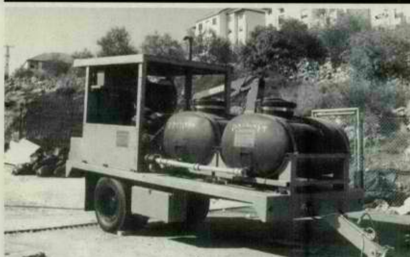
מכונת הביובית החדשה שרכשה המועצה. הביובית, שהיא בעלת מונקציות של שאיבה ודחיסה, מותחת סתימות קשות במיוחד, ושוטפת קווי ביוב בעייתיים.
